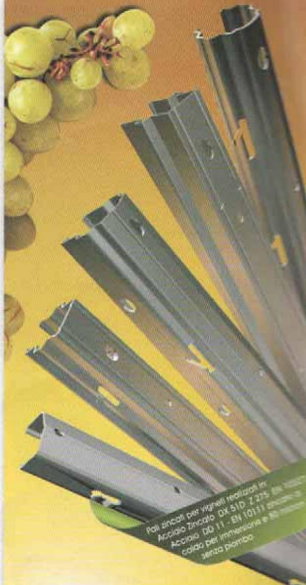
Pali zincati per vigneti realizzati in Acciaio Zincato DX 51D Z 275 EN 10223 caldo per immersione e 80 micron senza piombo
